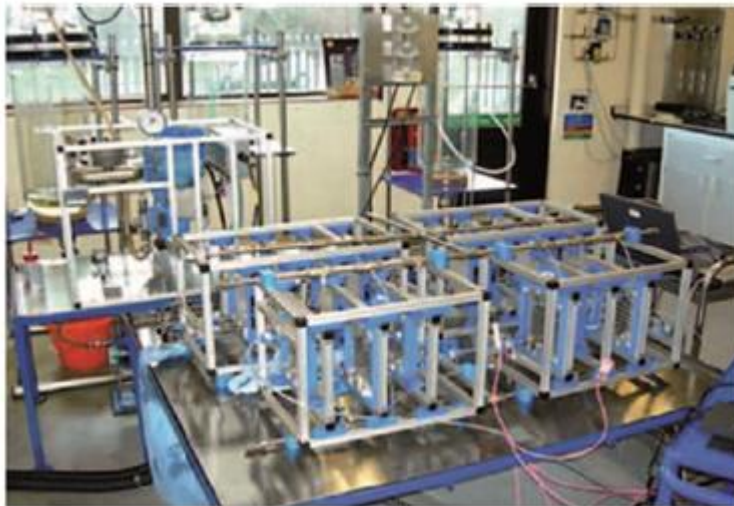
Figura 24. Reactor de flujo continuo para Hidrogenación de alto caudal utilizado en el Centro de Innovación de Procesos. Tomado de (Buisson, y otros, 2009).
