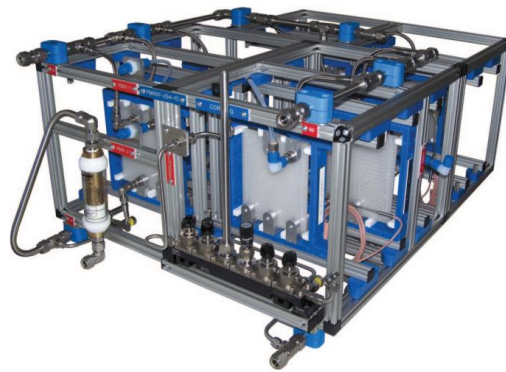
Figura 30. Microreactor que contiene 3 módulos de reacción para realizar reacciones en serie. Tomado de (Roberge, et al., 2008).
