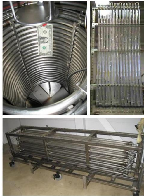
Figura 25. Reactores de flujo conectables (Plug Flow Reactors) de Eli Lilly para reacciones líquido-gas con tiempo de residencia prolongado: (arriba a la izquierda) reactor de bobinas en serie de 32 L; (arriba a la derecha) reactores de tubos verticales en serie de 14 L; (abajo) reactor de tubos horizontales en serie de 32 L. Tomado (Johnson, y otros, 2016).
