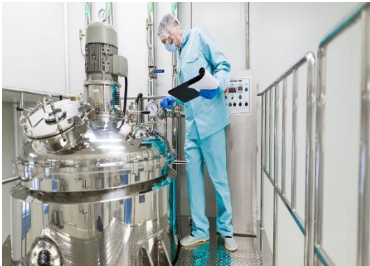
Figura 22. Reactores convencionales, empleados en la Manufactura por Lote. Se puede observar que son de gran tamaño y volumen y que generalmente solo tienen una entrada de carga y una salida para su descarga. Imágenes tomadas de (esferaingenieria.com), (Inoxtorres.com), (grupoacura.com) y (sctpharma.com).
