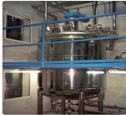
Figura 22. Reactores convencionales, empleados en la Manufactura por Lote. Se puede observar que son de gran tamaño y volumen y que generalmente solo tienen una entrada de carga y una salida para su descarga. Imágenes tomadas de (esferaingenieria.com), (Inoxtorres.com), (grupoacura.com) y (sctpharma.com).
