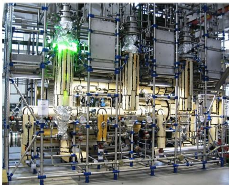
Figura 31. Reactor fotoquímico de Sanofi para la síntesis de Artemisinina. Tomado de (Turconi, et al., 2014).
