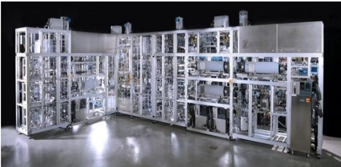
Figura 7. Planta piloto de Manufactura Continua de fármacos (API) suministrada por Zeton a GSK. Tomada de (Zeton.com, 2019).
